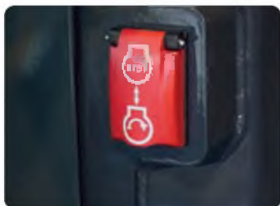
Nouzový vypínač motoru
