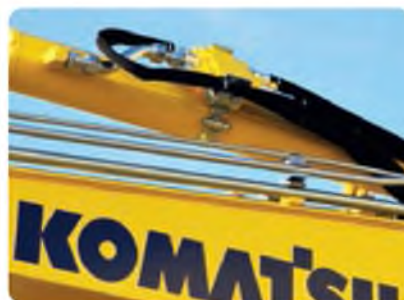
Hydraulické zámky výložníku a násady
